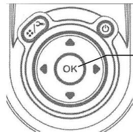
2. Для установки желаемой функции нажмите кнопку OK/установка.
