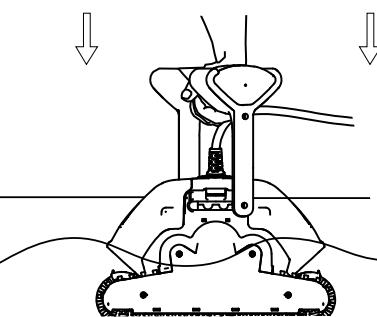
Примечание: При использовании комбинированной или Супер щетки во время погружения в воду слегка выжмите воздух из нее.
